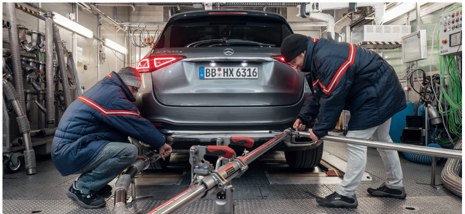
Depuis la norme Euro 6d-Temp, les mesures des émissions ne se font plus uniquement sur le banc d'essai. La confirmation des valeurs sur la route à l'aide d'appareils de mesure mobiles des émissions fait partie de l'homologation. Photo: Mercedes
