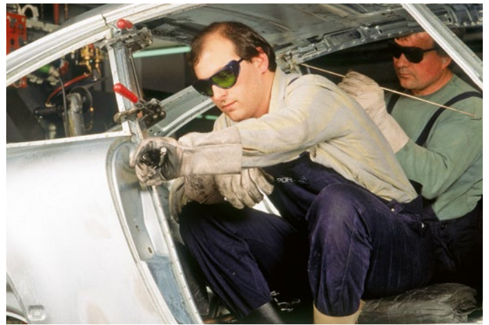
Carrosserie brute d'autrefois : les tôles de la carrosserie d'une Porsche 911 sont assemblées par soudage par points. Une grande partie du travail manuel entraîne des coûts de production élevés. Photo : Porsche
